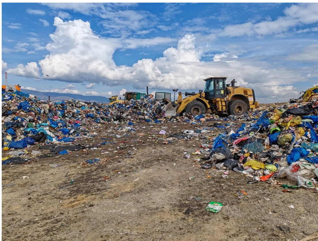
Slika 2. Postupak četvrtanja uzorka pomoću mehanizacije.
